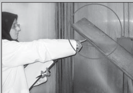
رسوب بر روی پروانه دستگاه ستر
